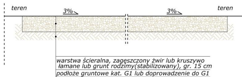
Rys. 6. Schemat przekroju konstrukcyjnego drogi dla rowerów, nawierzchnia gruntowa (ruch pieszy i rowerowy).
