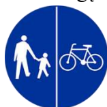
Rys. nr 79. Droga dla rowerów i droga dla pieszych. Kombinacja znaku C-13/C-16 z linią pionową (male Ø 60 cm, mini Ø 40).
