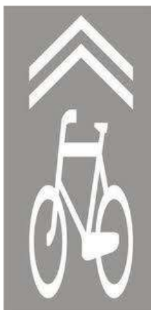
Rys. nr 87. Znak P-27 „kierunek i tor ruchu roweru” (wym. 71,5 cm x 195,0 cm).
