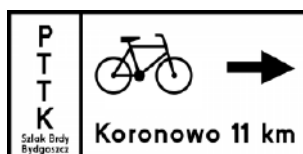
Rys. nr 52. Znak R-3 „tablica szlaku rowerowego lokalnego” wskazuje odległość do głównych miejscowości położonych przy szlaku rowerowym lokalnym (wym. 20,0 cm x 33,0/40,0 cm).
