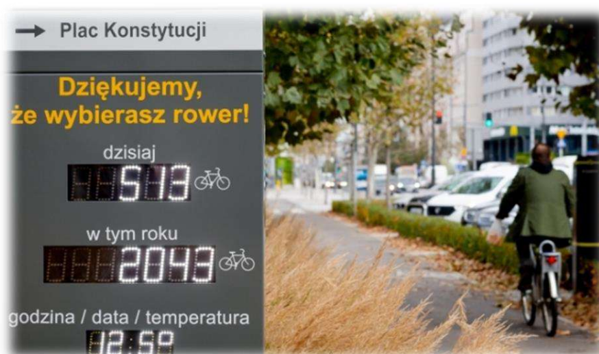
Foto nr 98. Licznik do zliczania rowerzystów na drodze dla rowerów w m.st. Warszawa. Źródło: m.st. Warszawa.
