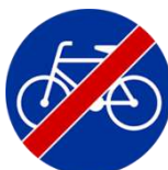
Rys. nr 77. Koniec drogi dla rowerów: Znak C-13a (male Ø 60 cm, mini Ø 40 cm).
