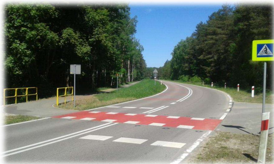
Foto nr 57. Droga poza obszarem zabudowanym. Przejazd dla rowerzystów w barwie czerwonej oraz znakiem pionowym D-6a „przejazd dla rowerzystów”.
