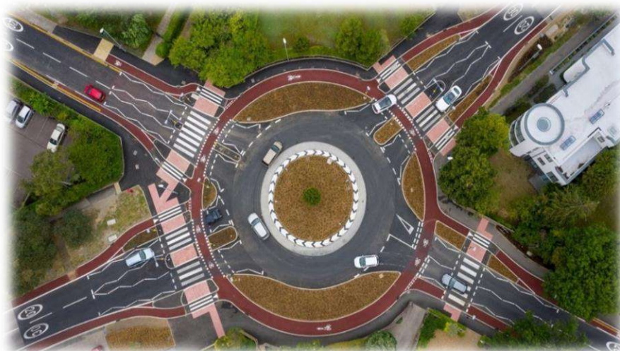
Foto nr 35. Przykład bezpiecznego ronda z wydzielonymi drogami dla rowerów i pierwszeństwem dla rowerzystów. Rozwiązanie wg Standardów holenderskich C.R.O.W. Źródło: Dutch Cycling Embassy, The Netherlands, 2020.
