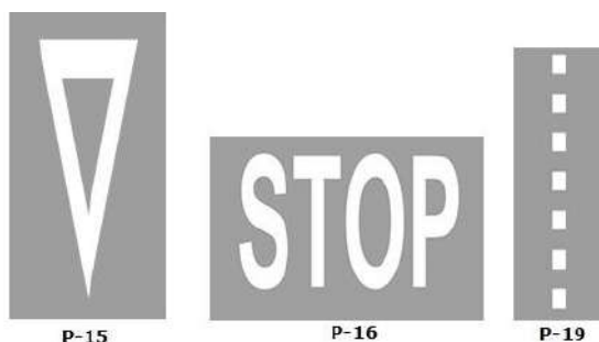
Rys. nr 91. Wzory znaków poziomych.
