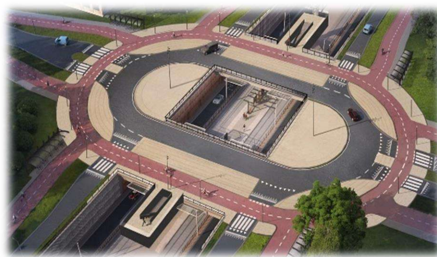
Foto nr 36. Przykład bezpiecznego ronda z wydzielonymi drogami dla rowerów i pierwszeństwem dla rowerzystów. Rozwiązanie wg Standardów holenderskich C.R.O.W. Źródło: Dutch Cycling Embassy, The Netherlands, 2020.
