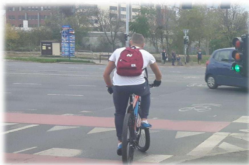
Foto nr 27. Ruch rowerowy na zasadach ogólnych na skrzyżowaniu z zastosowaniem znaków poziomych P-27 „kierunek i tor ruchu rowerów”.
