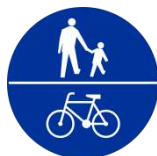
Rys. nr 78. Droga dla rowerów i pieszych. Znak C-13/16 z linią pionową (male Ø 60 cm, mini Ø 40 cm).
