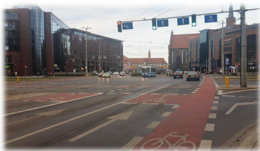
Foto nr 31. Śluza dla rowerów; umożliwiająca poruszanie się rowerem na wprost i w lewo.
