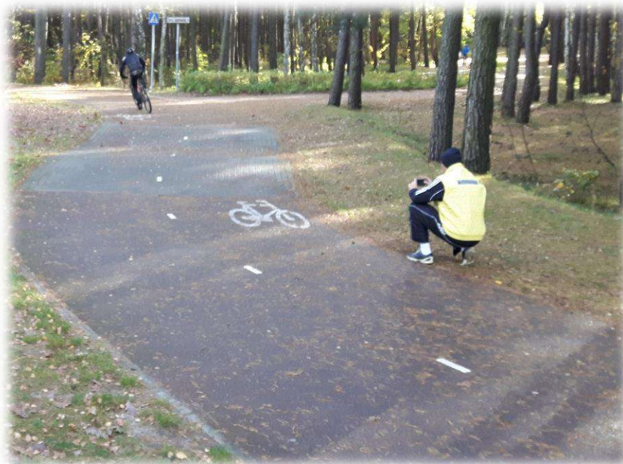
Foto nr 105. Rowersotrada (dwukierunkowa droga dla rowerów; 4 m szerokości, nawierzchnia asfaltowa), prowadzi wzdłuż Zatoki Gdańskiej.
