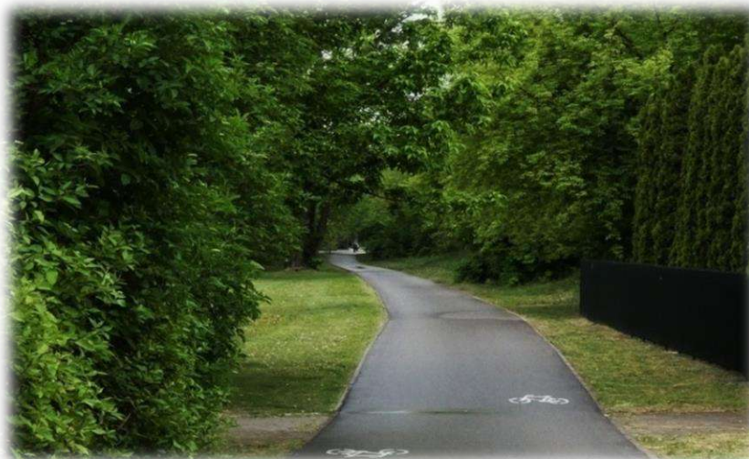
Foto nr 54. Droga dla rowerów w parku miejskim (dwukierunkowa), szerokość 2,5 m, nawierzchnia asfaltowa.
