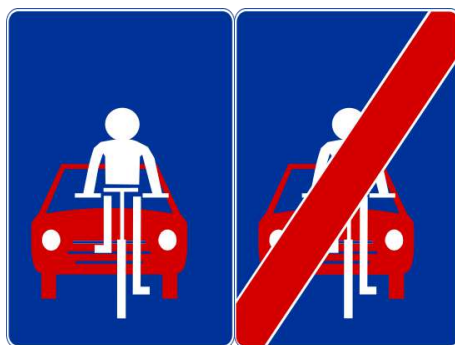
Rys. nr 107. Proponowane oznakowanie ulicy rowerowej (początek i koniec), wg wytycznych krajowych (2019).
