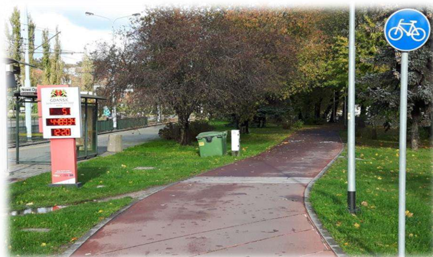
Foto nr 97. Pętla indukcyjna z licznikiem umieszczona na drodze dla rowerów w Gdańsku.
