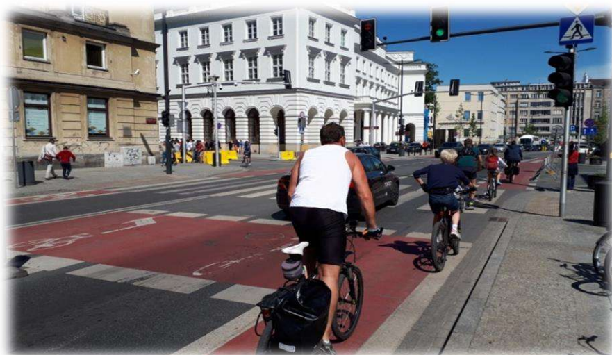
Foto nr 29. Śluza dla rowerów umożliwiająca jazdę na wprosi, w lewo i prawo. W śluzie umieszczono znaki P-8b mini z P-23 mini wyznaczające obszar oczekiwania rowerzystów jadących na wprost i skręcających w prawo i w lewo.
