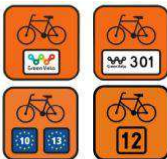
Rys. nr 55. Znak R-4 z numerem szlaku rowerowego (wym. 20 cm x 20 cm).
