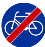
Rys. nr 35. Koniec drogi dla rowerów. Znak C-13a (małe Ø 60 cm, mini Ø 40 cm).
