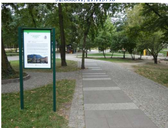
Foto nr 38 [w kierunku zachodnim] Park Zdrojowy Aleja Pisogne na wysokości Tężni Solankowej [droga dla rowerów i pieszych, nawierzchnia z kostki betonowej niefazowanej – szer. 3,1 m] 52.086221, 21.111987
