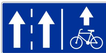
Rys. nr 38. Pasy ruchu dla rowerów. Znak F-19 z jednym rowerem (72,0 x 146,0) z dwoma rowerami (72,0 x 211,5).
