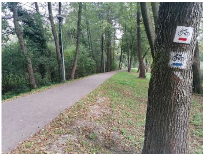
Foto nr 52 [w kierunku północno-wschodnim] Park Zdrojowy wzdłuż Jeziorki w kierunku ul. Warszawskiej [droga dla rowerów i pieszych, nawierzchnia z kostki betonowej niefazowanej – szer. 3,0 m] 52.086834, 21.111887
