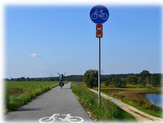
Fotografia 1. Wiślana Trasa Rowerowa (krajowa). Drukowana droga dla rowerów, nawierzchnia asfaltowa [oznakowanie pionowe i poziome].
