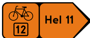
Rys. 56. Znak R-4d „drogowskaz tablicowy szlaku rowerowego (wym. 20 cm x długość zgodnie z rys. 9.10.10. Rozporządzenia).
