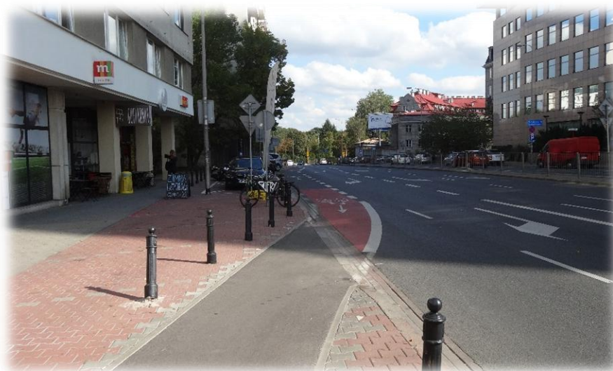
Foto 44. Wjazd z jednokierunkowego pasa ruchu dla rowerów (w barwie czerwonej) na jednokierunkową drogę dla rowerów.
