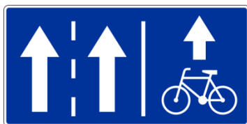
Rys. 77. Pasy ruchu dla rowerów: Znak F-19 z jednym rowerem (72,0 x 146,0) z dwoma rowerami (72,0 x 211,5).
