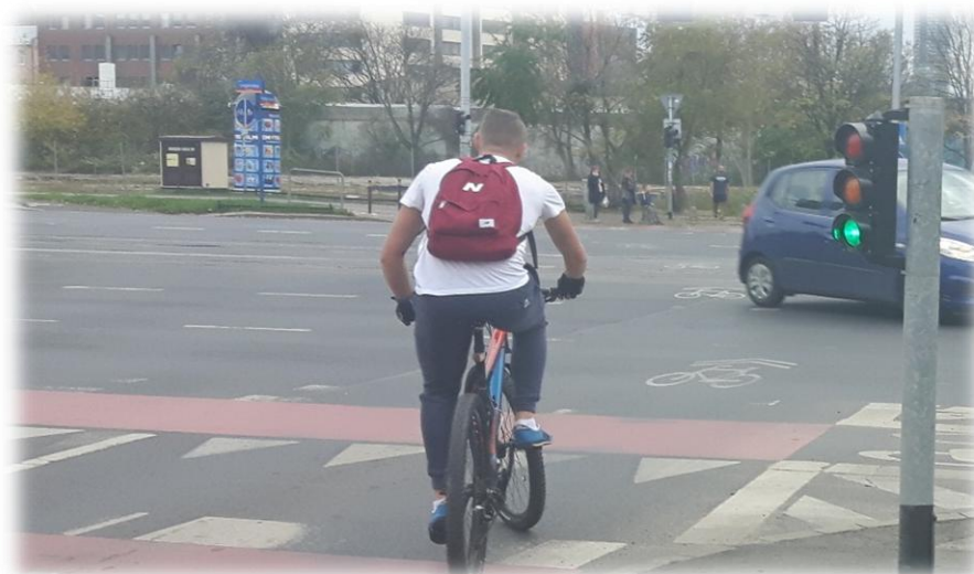
Foto 27. Ruch rowerowy na zasadach ogólnych na skrzyżowaniu z zastosowaniem znaków poziomych P-27 „kierunek i tor ruchu rowerów”.
