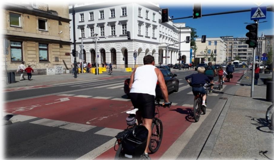
Foto 28. Śluza dla rowerów umożliwiająca jazdę na wprost, w lewo i prawo. W śluzie umieszczono znaki P-8b mini z P-23 mini wyznaczające obszar oczekiwania rowerzystów jadących na wprost i skręcających w prawo i w lewo.
