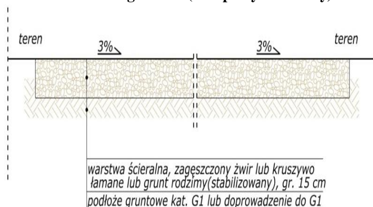
Rys. 70. Przekrój poprzeczny konstrukcji trasy rowerowej (nawierzchnia gruntowa).
