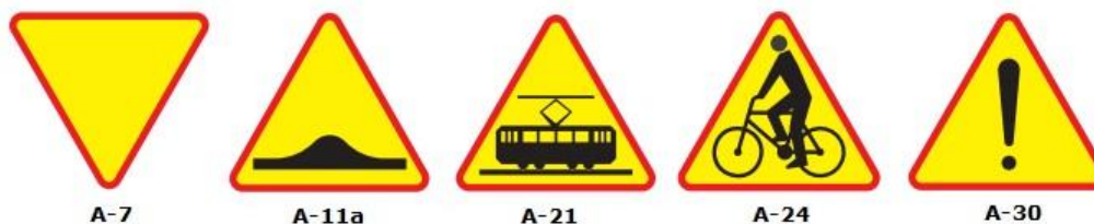
Rys. 78. Wzory znaków ostrzegawczych w ramach prowadzenia ruchu rowerowego.
