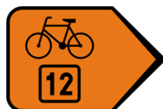
Rys. 54. Znak R-4b Zmiana kierunku szlaku rowerowego (wym. 20 cm x 30 cm).
