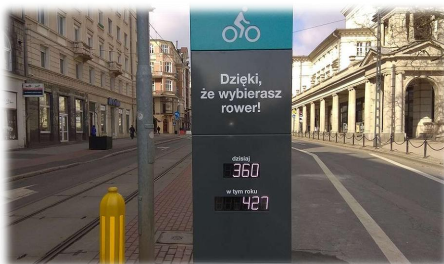
Foto 96. Licznik umieszczony na trasie rowerowej w Poznaniu.
