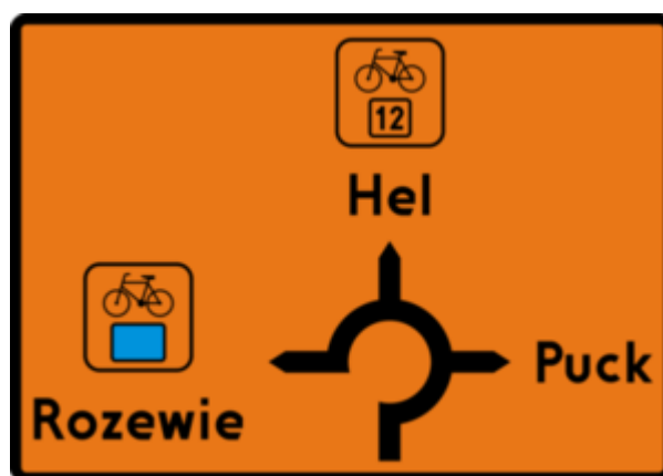
Rys. 57. Znak R-4e Tablica przeddrogowskazowa szlaku rowerowego. Wymiary zgodnie z rys. 9.10.12. Rozporządzenia.
