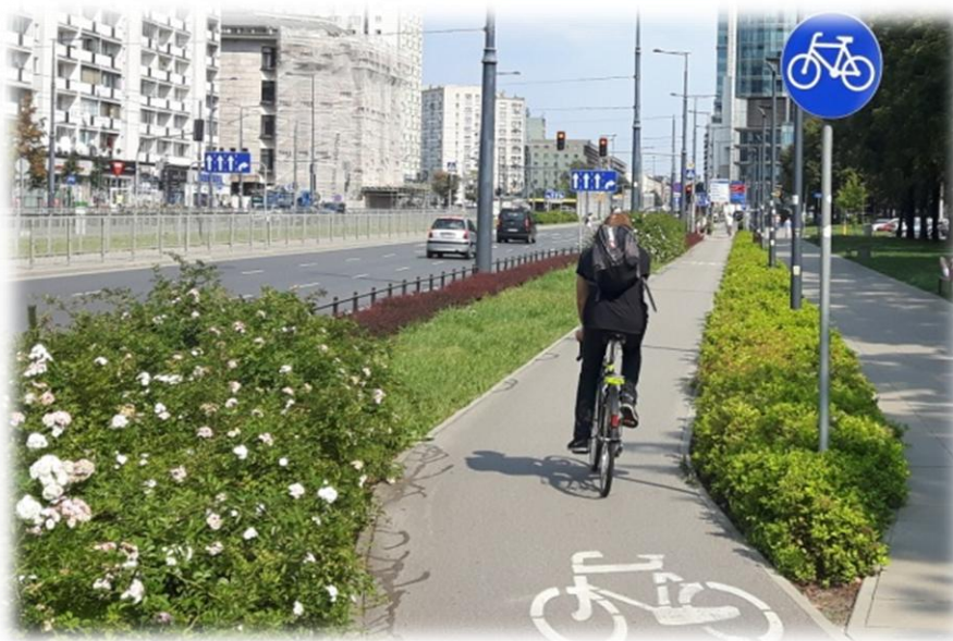
Foto 4. Wydzielona droga dla rowerów – jednokierunkowa (szerokość 1,5 m, nawierzchnia asfaltowa, oznakowanie pionowe C-13, oznakowanie poziome P-23).
