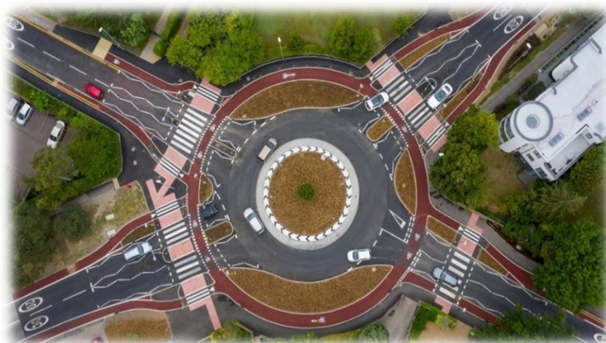
Foto 35. Rondo z wydzielonymi drogami dla rowerów i pierwszeństwem dla rowerzystów. Rozwiązanie wg Standardów holenderskich C.R.O.W. Źródło: Dutch Cycling Embassy, The Netherlands, 2020.
