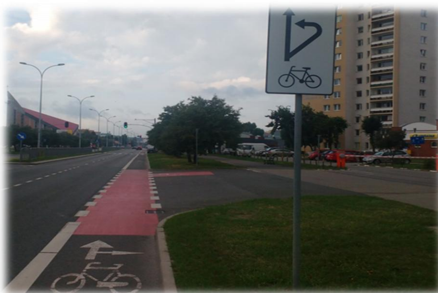
Foto 37. Pas ruchu dla rowerów naprowadzający na służę (azyl dla rowerzystów), który umożliwia skręt w lewo (bez sygnalizacji świetlnej).
