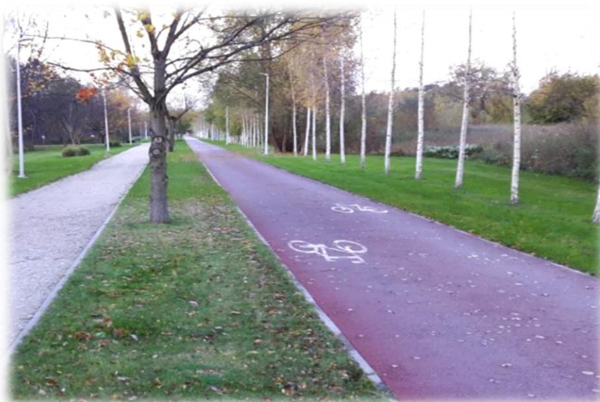
Foto 13. Zastosowanie separacji zieleni niskiej (trawnika) oraz drzew. Dodatkowym elementem jest zastosowanie nawierzchni dla rowerów w kolorze czerwonym. Trasa rowerowa o funkcji rekreacyjnej w parku miejskim.
