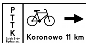
Rys. 48. Znak R-3 „tablica szlaku rowerowego lokalnego” wskazuje odległość do głównych miejscowości położonych przy szlaku rowerowym lokalnym (wym. 20,0 cm x 33,0/40,0 cm).
