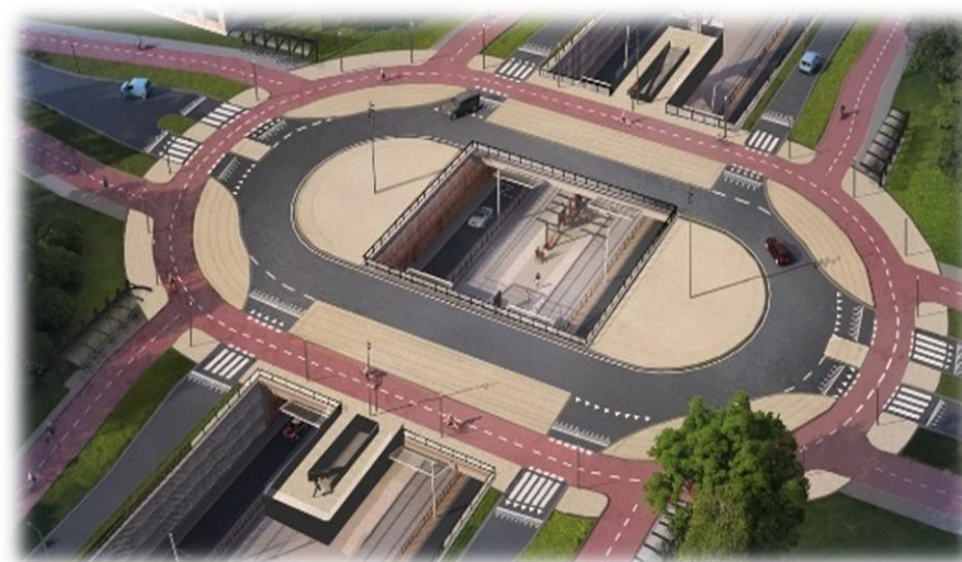
Foto 36. Rondo z wydzielonymi drogami dla rowerów i pierwszeństwem dla rowerzystów. Rozwiązanie wg Standardów holenderskich C.R.O.W. Źródło: Dutch Cycling Embassy, The Netherlands, 2020.
