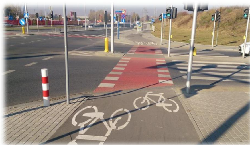
Foto 59. Przejazd dla rowerzystów w terenie zabudowanym na skrzyżowaniu z sygnalizacją świetlną. W obszarze zabudowanym również zaleca się stosowanie barwy czerwonej na przejeździe dla rowerzystów.
