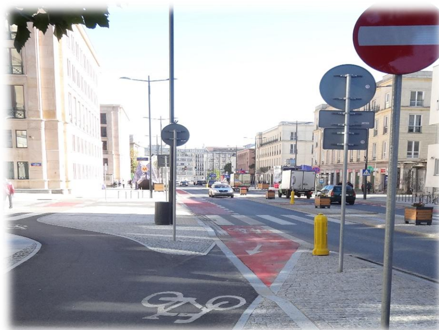
Foto 47. Wjazd z jednokierunkowego pasa ruchu dla rowerów (w barwie czerwonej) na jednokierunkową drogę dla rowerów.
