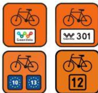
Rys. 51. Znak R-4 z numerem szlaku rowerowego (wym. 20 cm x 20 cm).
