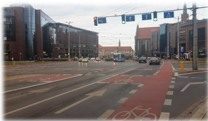
Foto 30. Śluza dla rowerów; umożliwiająca poruszanie się rowerem na wprost i w lewo.
