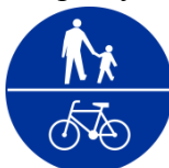
Rys. 75. Droga dla rowerów i pieszych. Znak C-13/16 z linią pionową (małe Ø 60 cm, mini Ø 40 cm).
