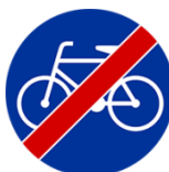
Rys. 74. Koniec drogi dla rowerów: Znak C-13a (małe Ø 60 cm, mini Ø 40 cm).
