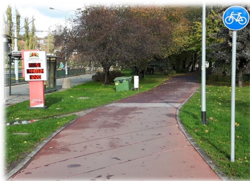
Foto 94. Pętla indukcyjna z licznikiem umieszczona na drodze dla rowerów w Gdańsku.
