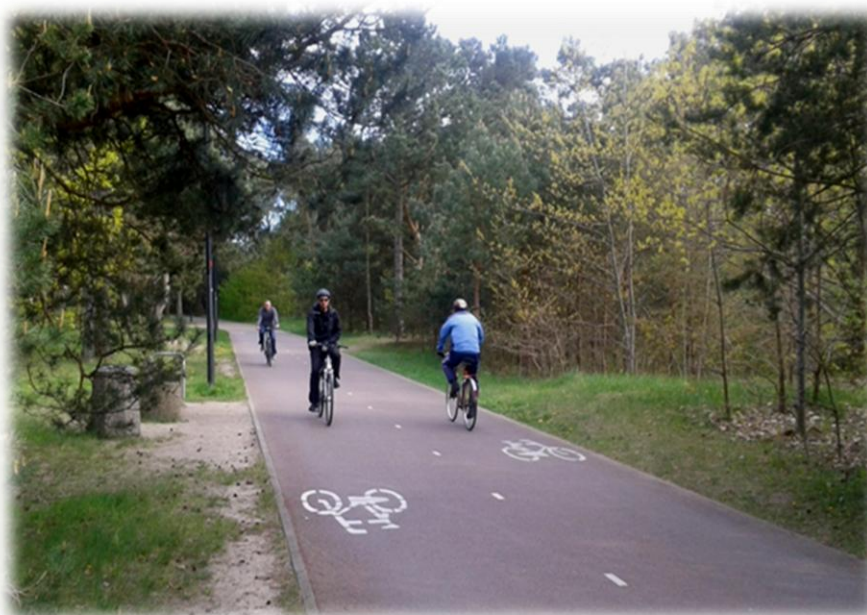
Foto 52. Trasa rowerowa (rowerostrada) w obszarze parku miejskiego, 4 m szerokości, nawierzchnia asfaltowa. Rowerostrada w parkach jest zalecana w sytuacji dużego ruchu turystycznego.
