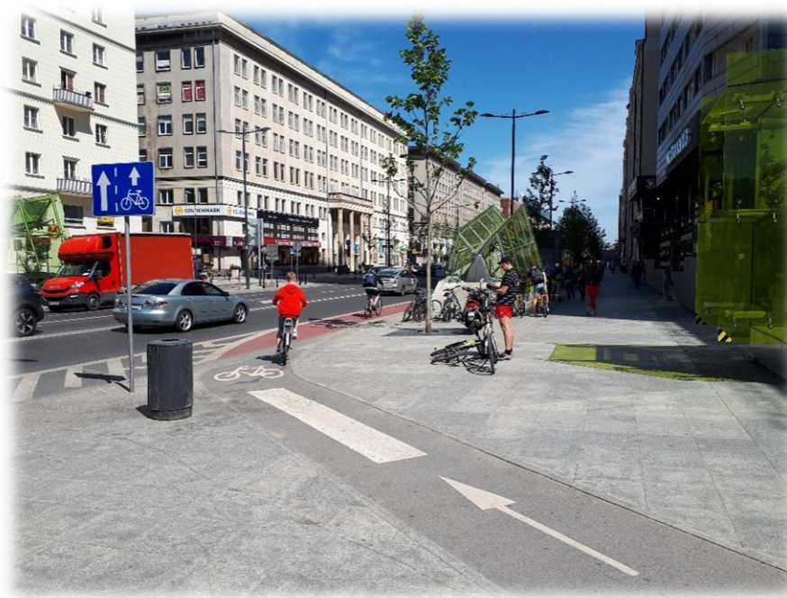
Foto 42. Zjazd z jednokierunkowej drogi dla rowerów na jednokierunkowy pas ruchu dla rowerów (w barwie czerwonej).
