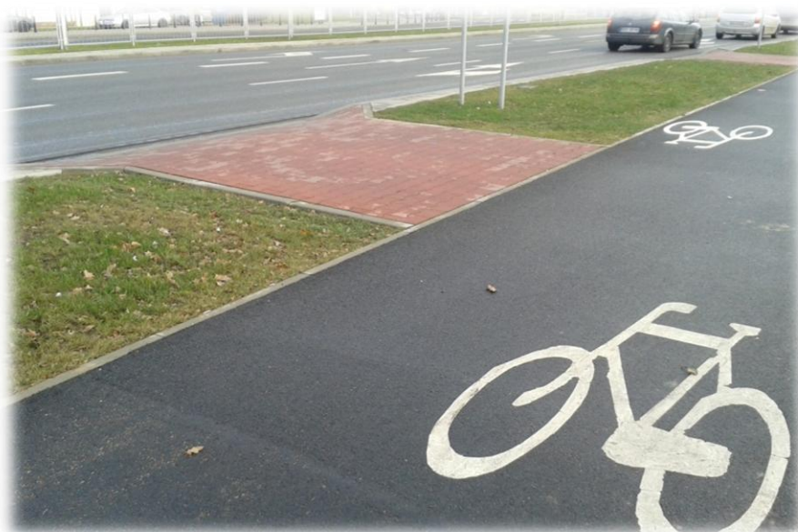
Foto 9. Przykład prawidłowo zaprojektowanej drogi dla rowerów przy wjeździe do posesji.
