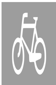
Rys. 83. Symbol roweru. Znak P-23 (wym. 71,5 cm x 130,0 cm) Znak P-23 mini (wym. 46,5 cm x 84,5 cm).
