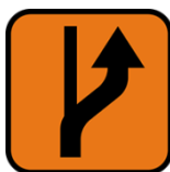
Rys. 53. Znak R-4a Informacja o rzeczywistym przebiegu szlaku rowerowego (wym. 20 cm x 20 cm).
