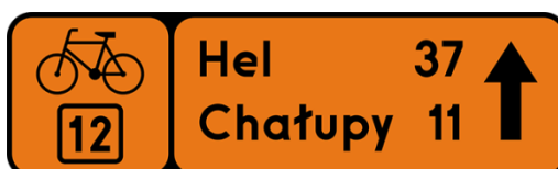
Rys. 55. Znak R-4c „drogowskaz tablicowy szlaku rowerowego (wym. 20 cm x długość zgodnie z rys. 9.10.10. Rozporządzenia).
