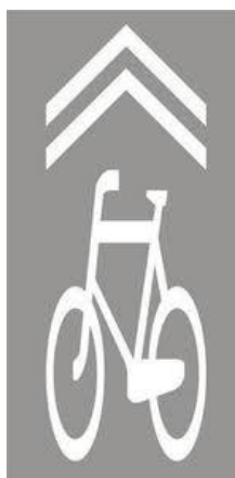
Rys. 84. Znak P-27 „kierunek i tor ruchu roweru” (wym. 71,5 cm x 195,0 cm).
