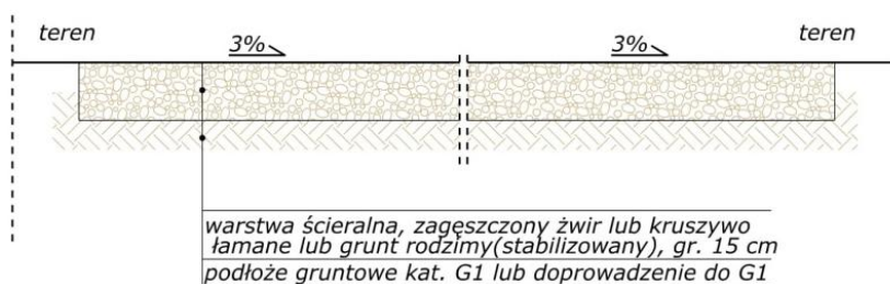
Rys. nr 6. Schemat przekroju konstrukcyjnego drogi dla rowerów, nawierzchnia gruntowa (ruch pieszy i rowerowy).
