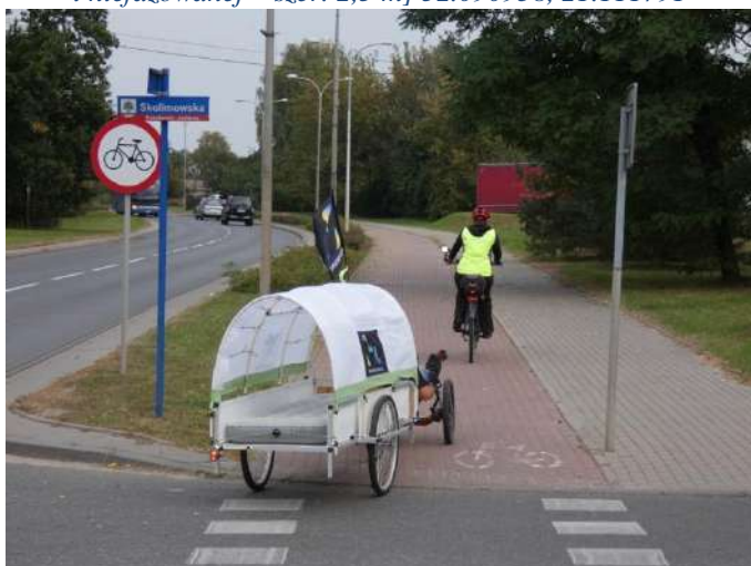
Foto nr 29 [w kierunku wschodnim] ul. Piaseczyńskiej skrzyżowanie z ul. Skolimowską [droga dla pieszych i droga dla rowerów, nawierzchnia z kostki betonowej fazowanej szer. – 2,0 m i niefazowanej – szer. 2,5 m] 52.090970, 21.111999
