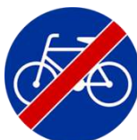
Rys. 35. Koniec drogi dla rowerów. Znak C-13a (male Ø 60 cm, mini Ø 40 cm).
