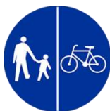
Rys. 37. Droga dla rowerów i droga dla pieszych. Kombinacja znaku C-13/C-16 z linią pionową (małe Ø 60 cm, mini Ø 40).
